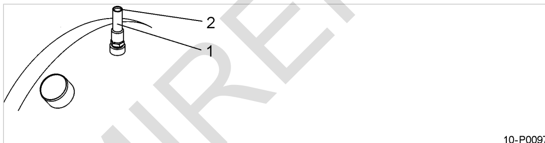
Рис. 13 Предохранительный клапан на ресивере
